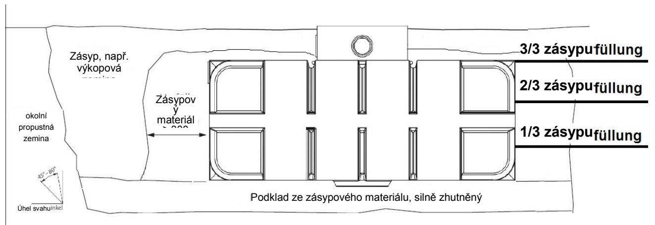
Obrázek 4: Provedení instalace na příkladu ploché nádrže Ozeanis 1 700 I s poklopem nádrže Basic
